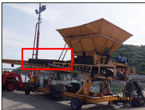
รูปที่ 2-13 แผ่นยางป้องกันการร่วงหล่น บริเวณสายพานลำเลียง
